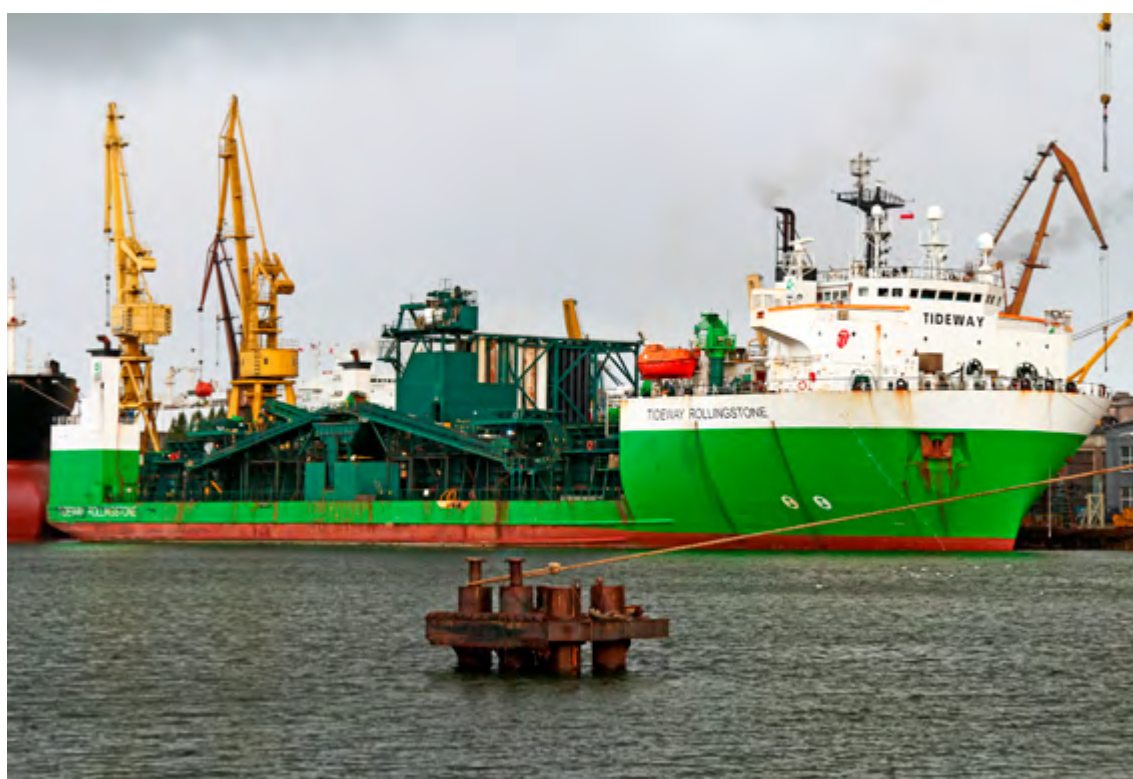
Fall pipe vessel lub podsypkowiec Tideway Rollingstone w stoczni Remontowa SA.
