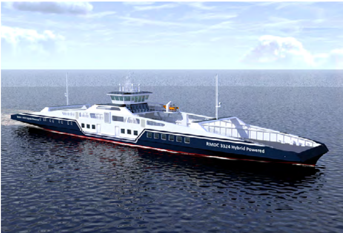
Prom pasażersko-samochodowy z napędem hybrydowym projektu RMDC.
