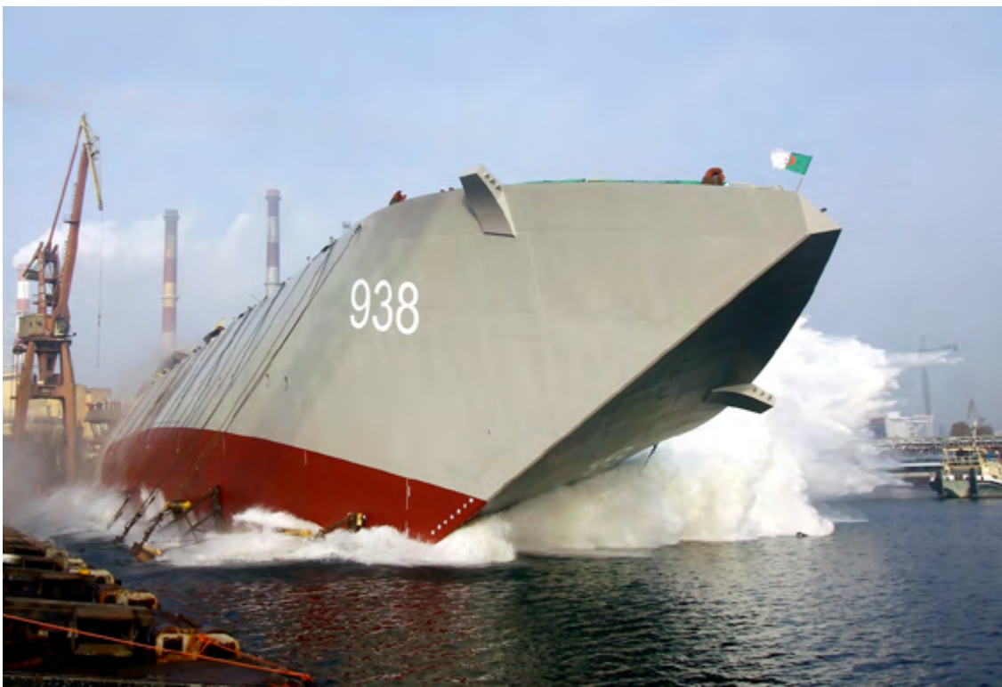
Wodowanie kadłuba żaglowca dla Algierii Fot.: Jakub Bogucki
