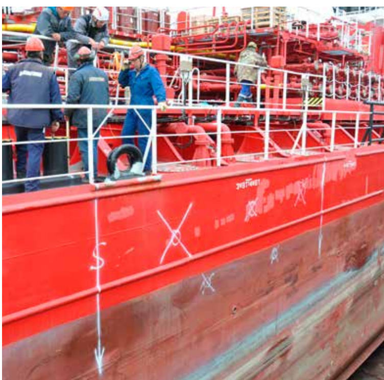
W tych miejscach został przecięty kadłub statku. Fot.: J. Uklejewski
