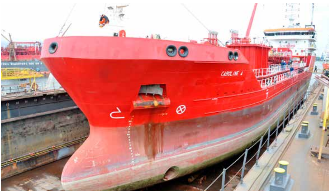
Chemikaliowiec, jeszcze przed skróceniem, w stoczniowym doku. Fot.: J. Uklejewski
